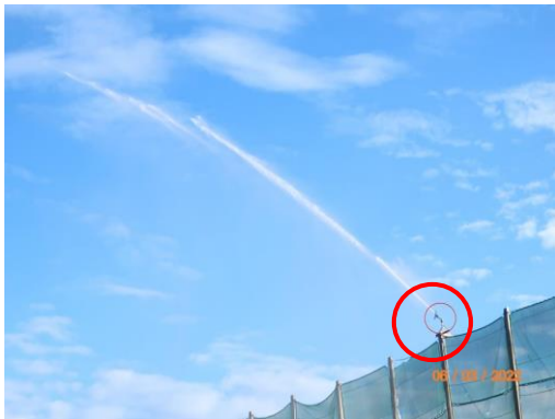
รูปที่ 12 อุปกรณ์การฉีดพรมน้ำบริเวณกองขานอ้อย
