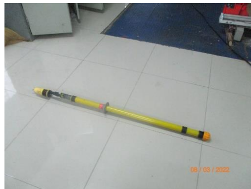
รูปที่ 51 อุปกรณ์ป้องกันไฟฟ้าแรงสูง
